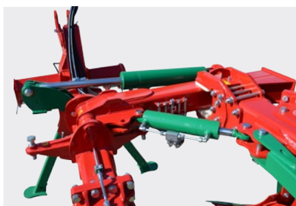
Hydraulické nastavení záběru první radlice ArcoAgro
